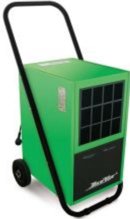
Новые модели осушителей DanVex DEH- 900i оснащены емкостью для конденсата на 10 литров. Теперь при покупке высокопроизводительного осушителя, не теряя времени на прокладку канализации для слива конденсата, вы немедленно запускаете его в работу! Автоматический контроль от переполнения емкости ведется с помощью фотоэлемента.
